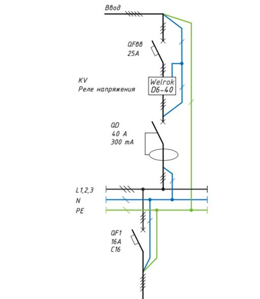
Схема 2. Вариант электрической схемы с трехфазной нагрузкой
